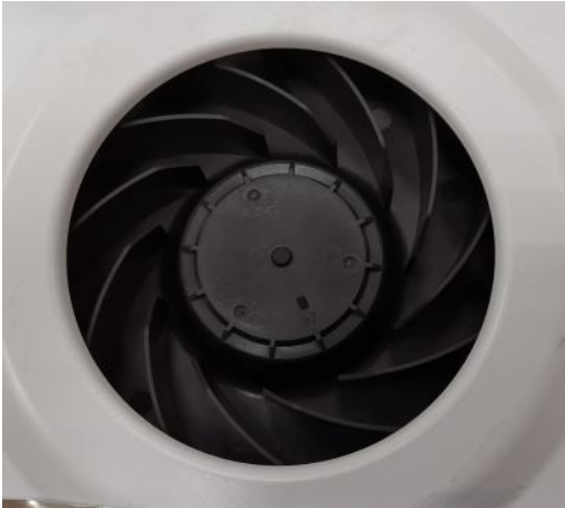
Refrigerator fan motor
