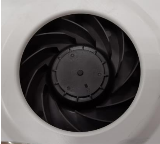
Refrigerator fan motor
